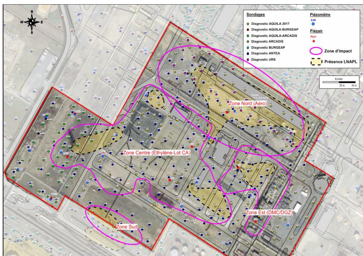
Localisation des zones non saturées dont les teneurs sont supérieures aux seuils de réhabilitation
